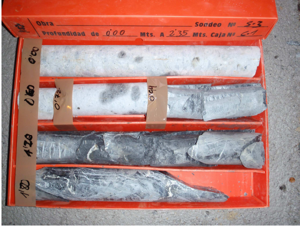
[Fig. 4].- Testigo obtenido en el que se aprecia con claridad en tramo de roca, el revestimiento provisional de gunita y el revestimiento de la bóveda de hormigón.
