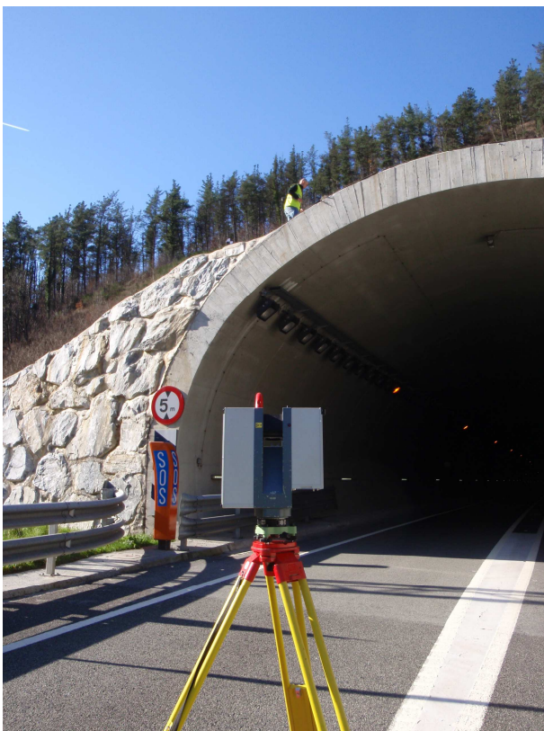
[Fig. 1].- Medición de falsos túneles, taludes de emboquille, e interior del túnel mediante láser escáner
